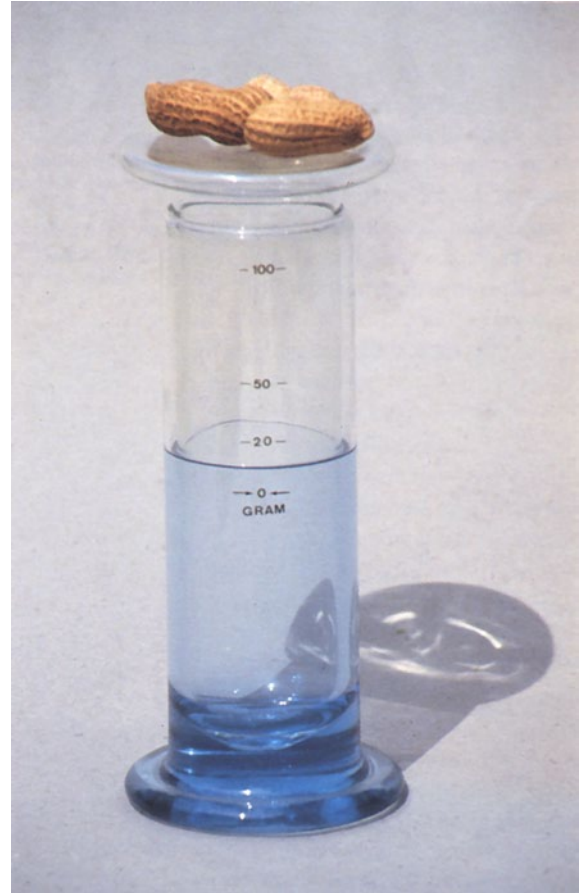
[4.6] Arnout Visser – ‘Archimedes’ brievenweger – 1990-1991, het werkingsprincipe is bij dit object duidelijk zichtbaar.
